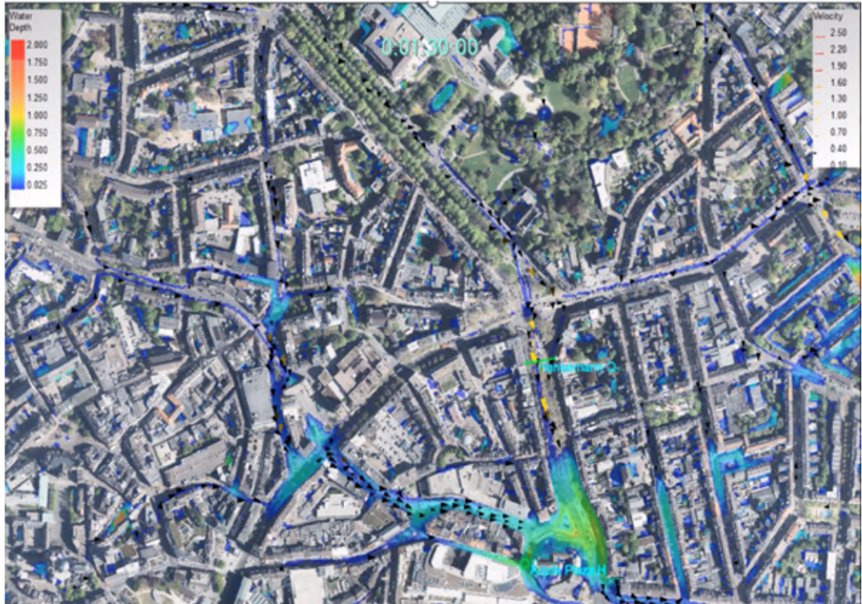
Detalles del modelado de inundación: las flechas indican la dirección y la velocidad del flujo
